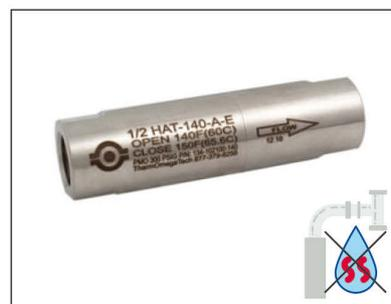
**ISC902** Kit anti-scald per lavaocchi. Previene il surriscaldamento dell'acqua. Una valvola termostatica apre il circuito a 40°C e lo chiude quando l'acqua torna sotto i 35°C. Misura 1/2".
