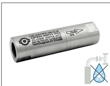
**ISC901** Kit anti-freeze per lavaocchi. Previene il congelamento dell'acqua. Una valvola termostatica apre il circuito a 1,7°C e lo chiude quando l'acqua torna sopra i 4,4°C. Misura 1/2".
