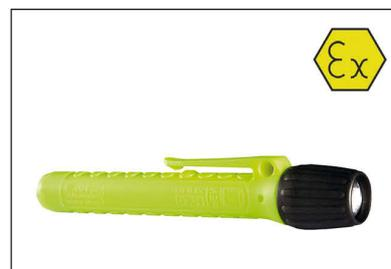
**2317 PX3** Torcia a LED tre volte più luminosa di altre. Dimensioni ridotte tanto da poter essere tenuta nel taschino della camicia. Certificata per l'uso in aree pericolose ATEX (zona 1+21). Corpo in ABS giallo fluo, IP67, 35lm, portata 64 mt., autonomia 3 ore, 2 batterie AAA incluse.
